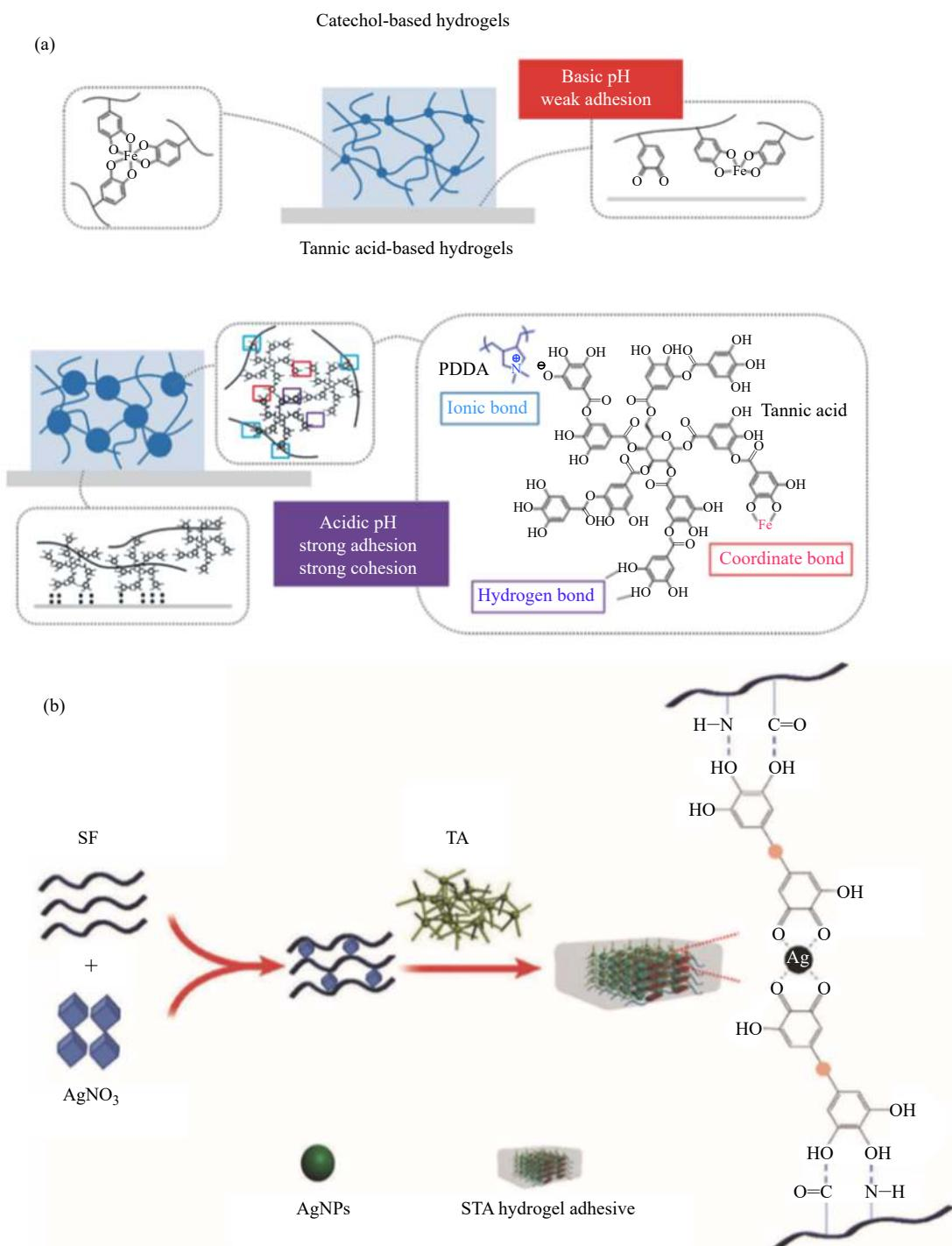
图 8 TA 基胶黏剂的合成<sup>[77, 78]</sup>
